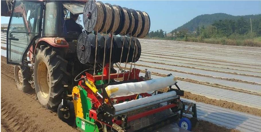
Gambar 13. Mesin tanam bawang putih tanpa mulsa plastik dan mesin tanam dengan mulsa plastic
