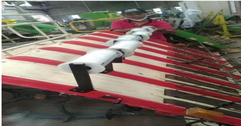
Gambar 9. Rangka penyangga roll modifikasi 1
