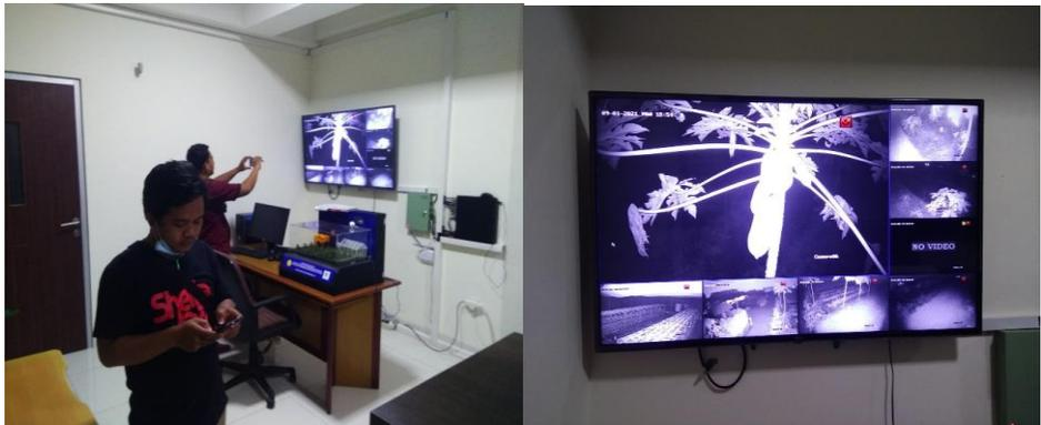
Gambar 52. Uji Coba Fungsi Infra Red unit CCTV pada Malam Hari
