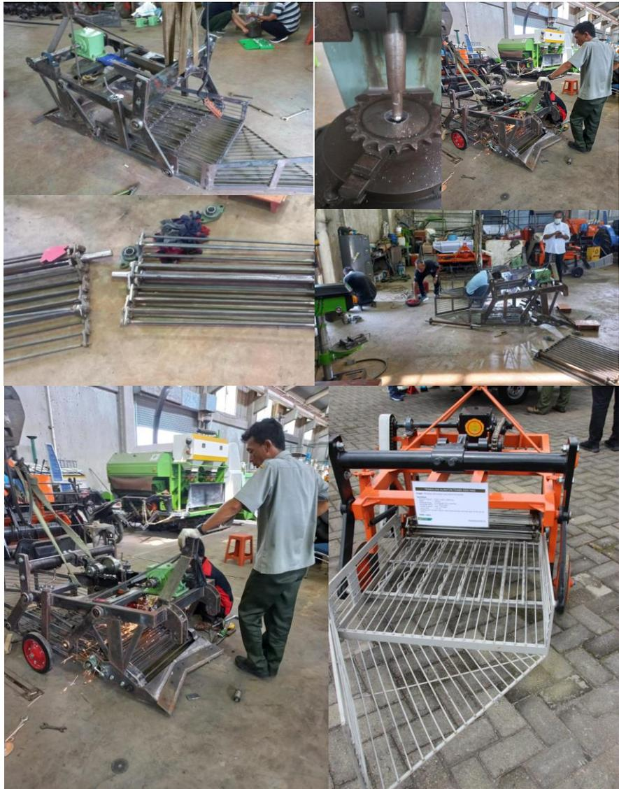
Gambar 41. Proses dan Hasil Pembuatan Alat Pemanen Kentang
