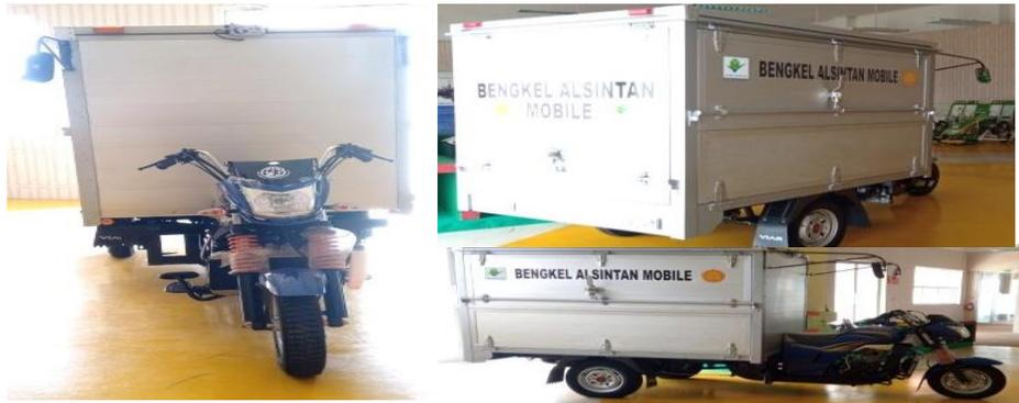
Gambar 7. Prototipe bengkel alsintan berjalan roda tiga
