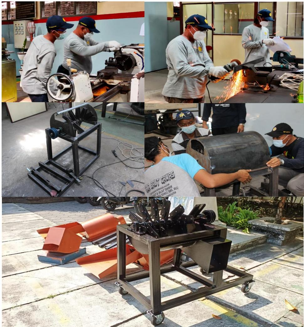
Gambar 42. Proses dan Hasil Pembuatan 2 unit Alsin Chopper
