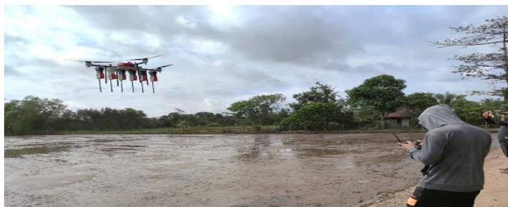
Gambar 1. Uji unjuk kinerja drone penebar benih tipe baris
