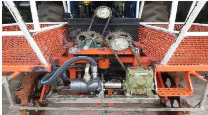
Gambar 4. Komponen pisau pemotong setelah modifikasi penggerakannya
