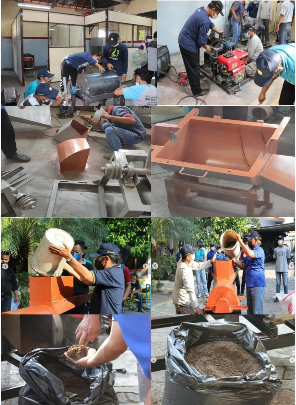
Gambar 62. Finishing dan uji fungsi Alsin Chopper
