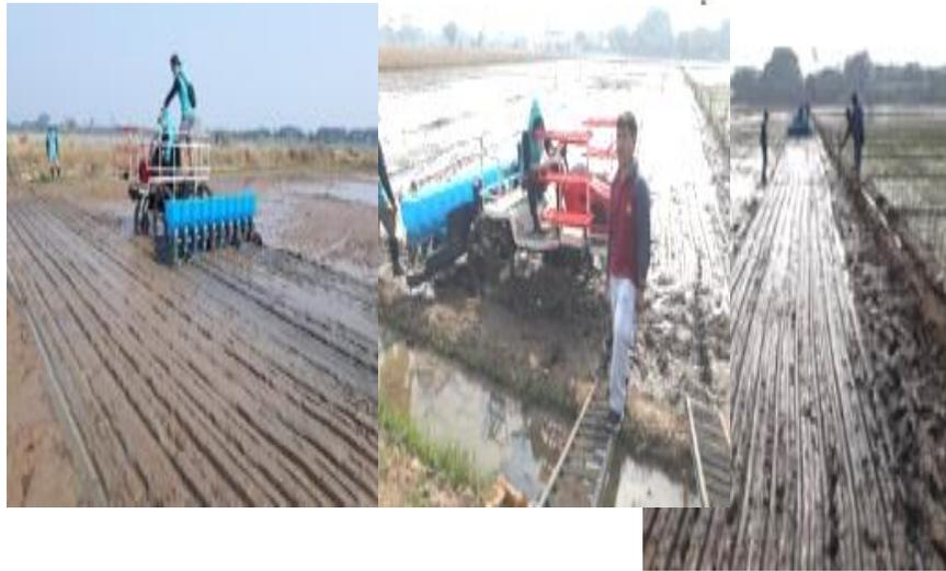
Gambar 4. Uji lapang mesin tanam direct seeder untuk lahan sawah
