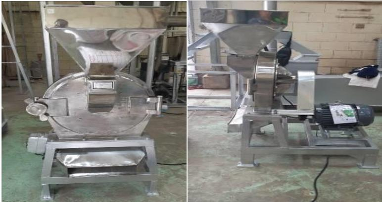
Gambar 12. Prototipe mesin penepung bijian tipe *disk mill*
