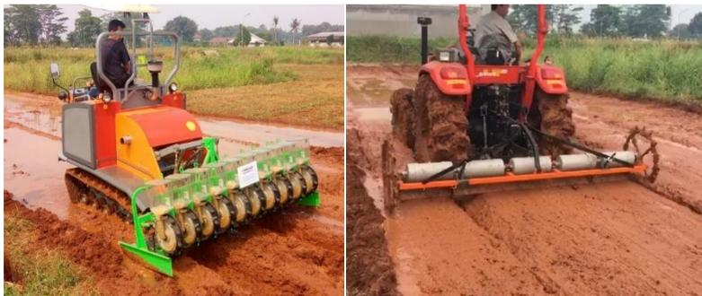
Gambar 10. Modifikasi dan pengujian *drum seeder* dan pengujian *power seeder*
