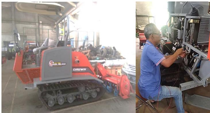
Gambar 1. Unit Traktor Crown CTC 750 Kelabang dan Perakitan Sistem Kendali
