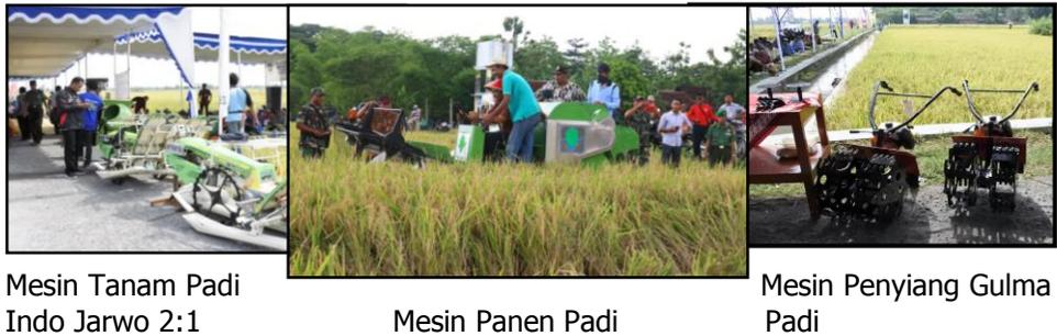
Gambar 4. Alat Mesin Pertanian Yang Digunakan Mesin *Transplanter* Padi Tipe Jajar Legowo 2:1, Mesin Penyang Gulma Padi dan Mesin Pemanen Tipe *Combine Harvester* Padi
