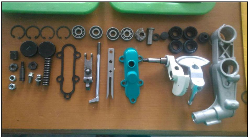
Gambar 6. *Komponen-komponen Penyusun Finger Planting Mesin Rice Transplanter*
