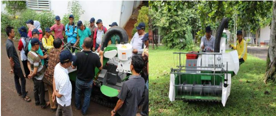
Gambar 37. Praktek Pengoperasian dan Perawatan Mini Combine Harvester
