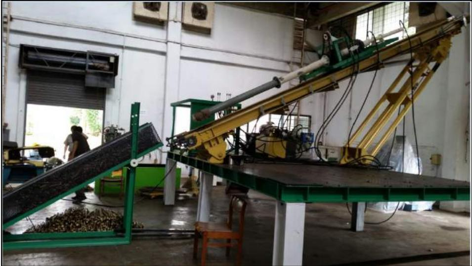
Gambar 16. Core Sampler dan Spesifikasi Teknis Hasil Kegiatan
