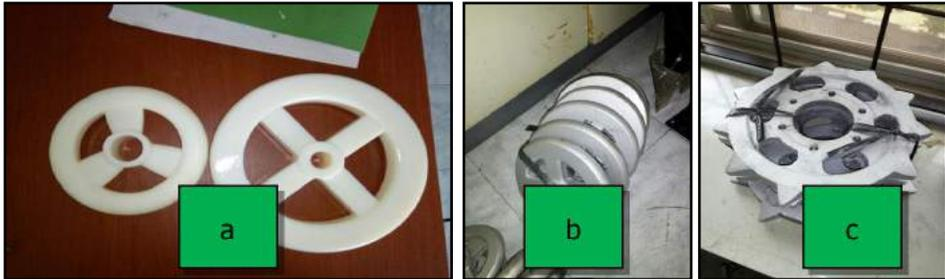
Gambar 22. (a) Hasil Desain dan Printer dengan Pinter 3D, (b) dan (c) Hasil pembuatan Coran Logam dari 3D Printer komponen Mini Combine Harvester
