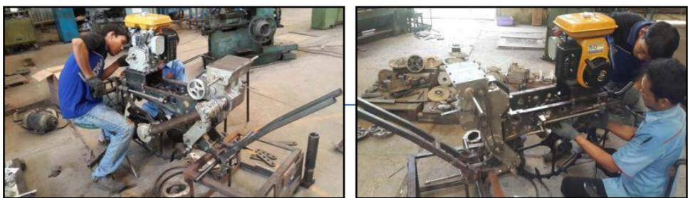
Gambar 7. Proses Pengujian Fungsi Gearbox *Transplanter*, Putaran Roda, dan Planting Arm
