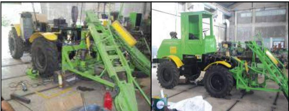
Gambar 15. Proses Modifikasi Prototipe Mesin Panen Tebu 2016
