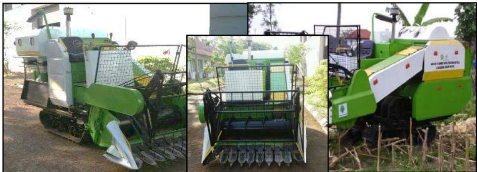
Gambar 12. Prototipe Mesin Panen Jagung Tipe Kombinasi
