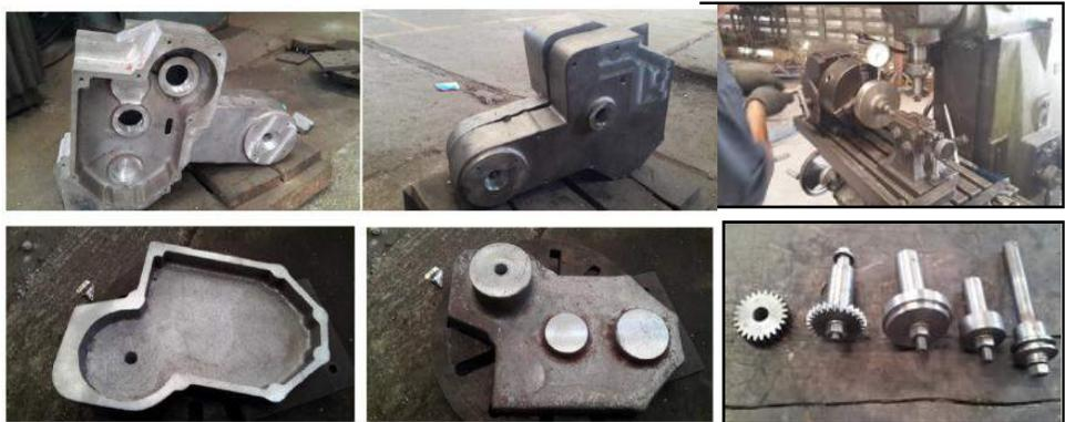
Gambar 5. Proses Pabrikasi Komponen Gearbox Utama
