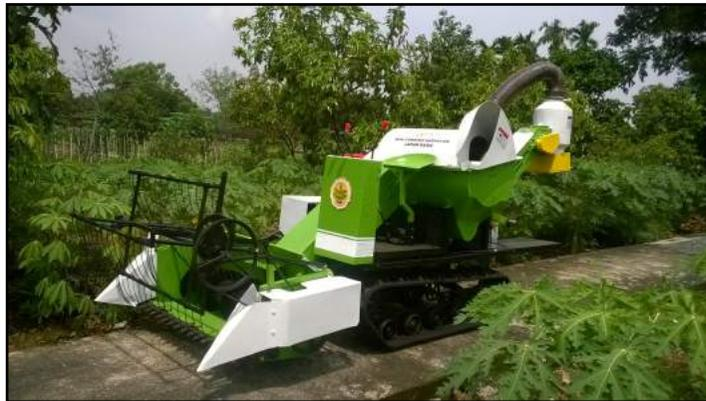
Gambar 8. Prototipe Mesin Panen Padi Tipe *Mini Combine Harvester* untuk Lahan Rawa Pasang Surut
