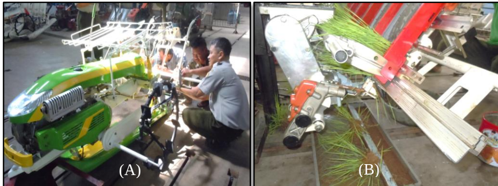
Gambar 2. Proses Perakitan Komponen Mesin Transplanter (A) dan Uji Fungsional Mesin Transplanter di BBP Mektan Serpong (B)
