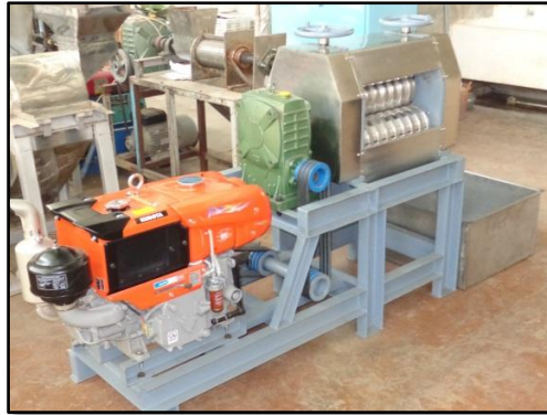
Gambar 10. Mesin Pemas Tebu
