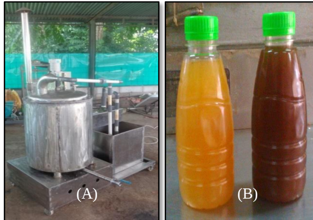
Gambar 12. Mesin Evaporator vacuum (A), Nira Murni (kiri) dan Gula Tebu Cair, 32° Brix (kanan) (B)
