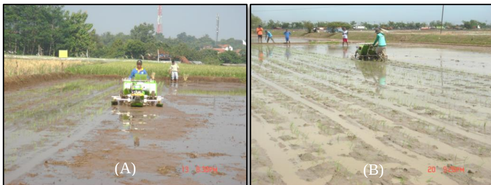
Gambar 3. Pengujian Mesin Tanam Pindah Bibit Padi Sawah 4 Baris Sistem Jajar Legowo 2:1 di KP. Muara Bogor (A) dan KP Sukamandi Subang (B)
