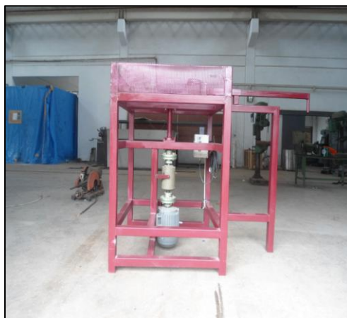
Gambar 29. Aparatus uji torsi pemotongan batang tebu
