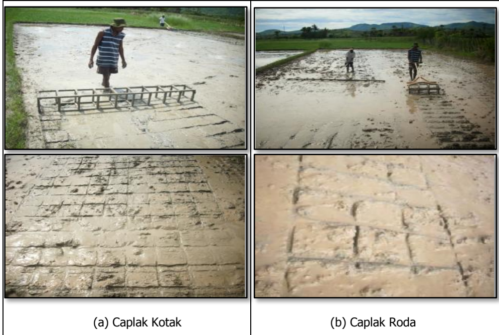
Gambar.37. Dua Jenis Alsin Caplak Pembuat Alur Tanam Saat Dioperasikan di Sawah
