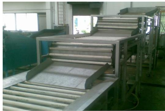
Gb.5. Bagian hopper dan pengumpan dari Mesin grading kentang
