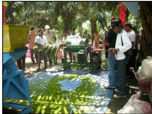
Gb.17. Demo alat mesin pengolah pakan dari pelepah sawit pada Alsin untuk SITT Sawit-Sapi
