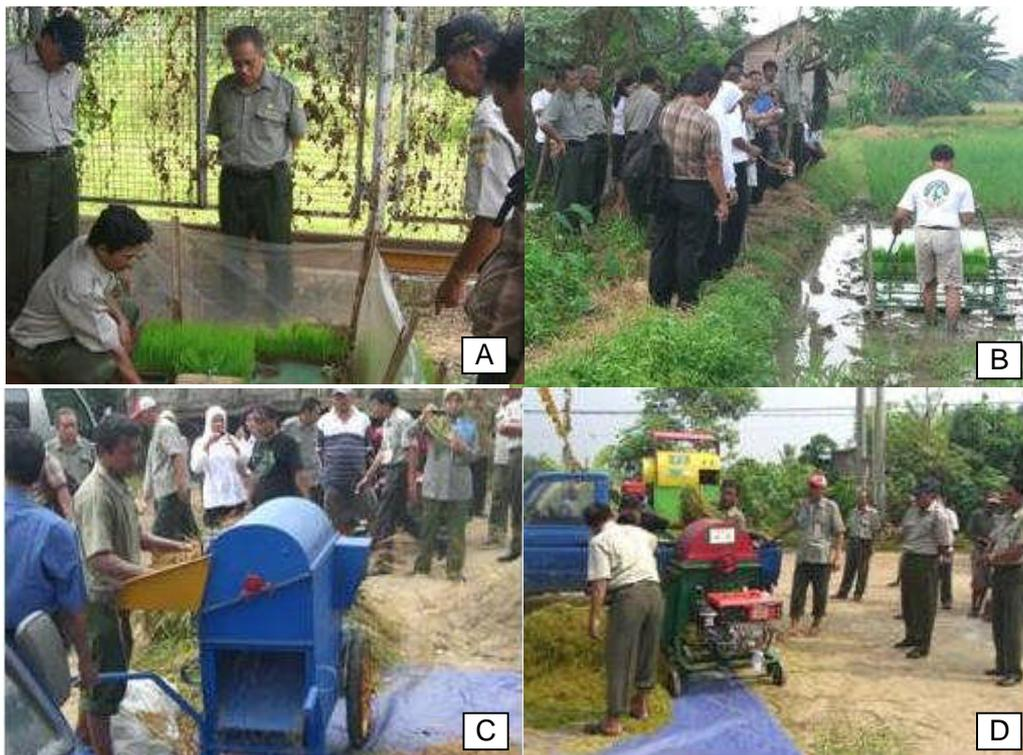
Gambar 2. Demonstrasi penggunaan dapog persemaian (A), alat tanam pindah benih padi (B), pengoperasian mesin perontok (C) dan pengoperasian APPO (D)
