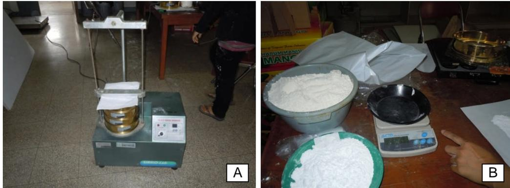
Gambar 8. Pengujian laboratorium Mesh Tepung (A) dan Derajat Putih Tepung (B).
