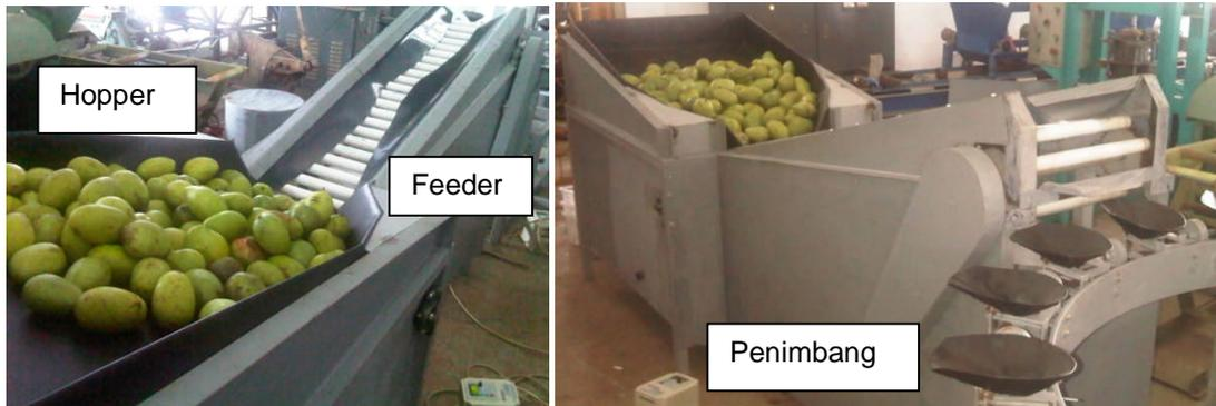
Gambar 13. Komponen utama dari mesin grading buah saat dioperasikan.
