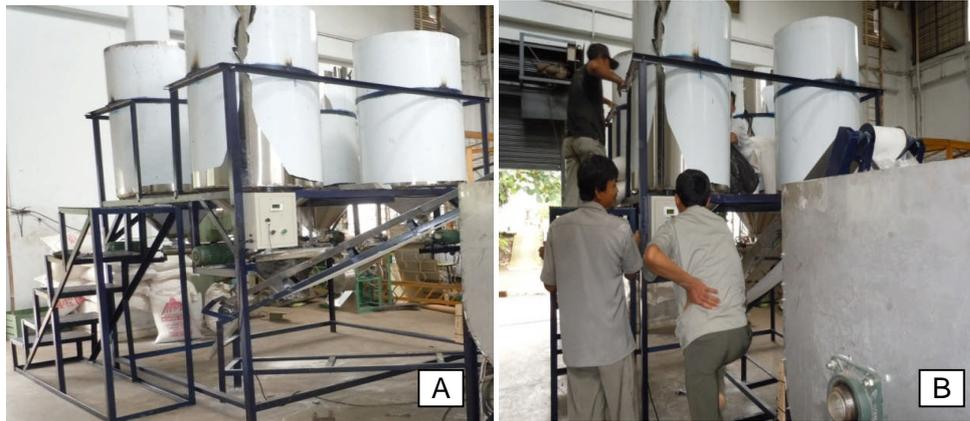
Gambar 6. Silo penampung / Feeder (A) dengan sensor pengatur waktu loading (B).
