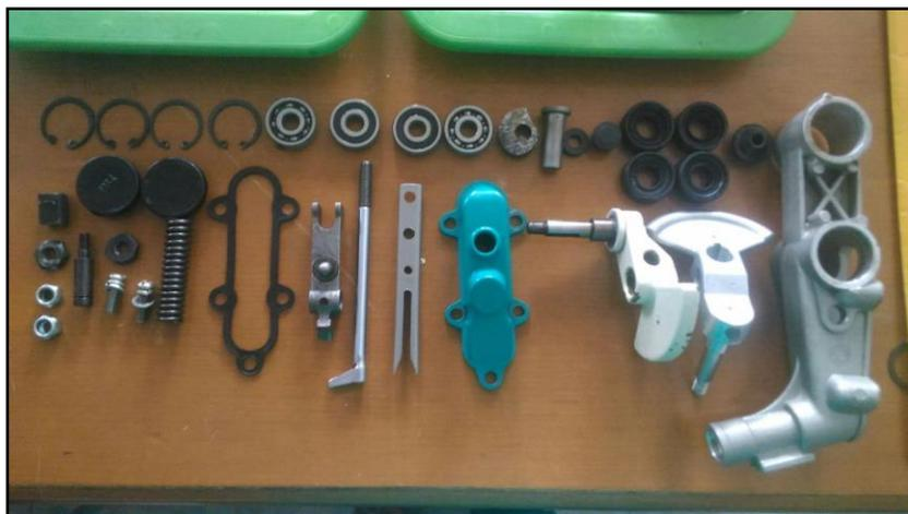
Gambar 6. Komponen-komponen Penyusun *Finger Planting* Mesin *Rice Transplanter*
