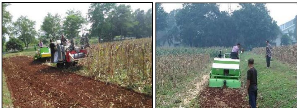
Gambar 2. Kinerja Mesin Rotavator pada Lahan Setelah Panen Jagung
