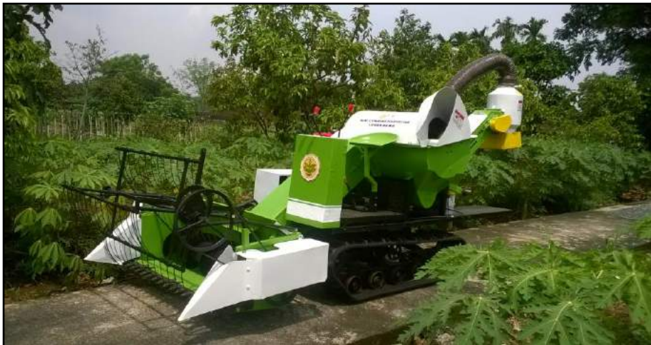
Gambar 4. Prototipe Mesin Panen Padi Tipe Mini Combine Harvester untuk Lahan Rawa Pasang Surut
