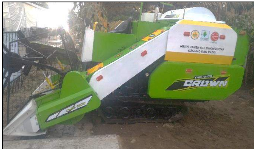
Gambar 8. Mesin Pemanen Tipe Kombinasi dengan Merk CROWN (Lisensi dengan PT. RUTAN)
