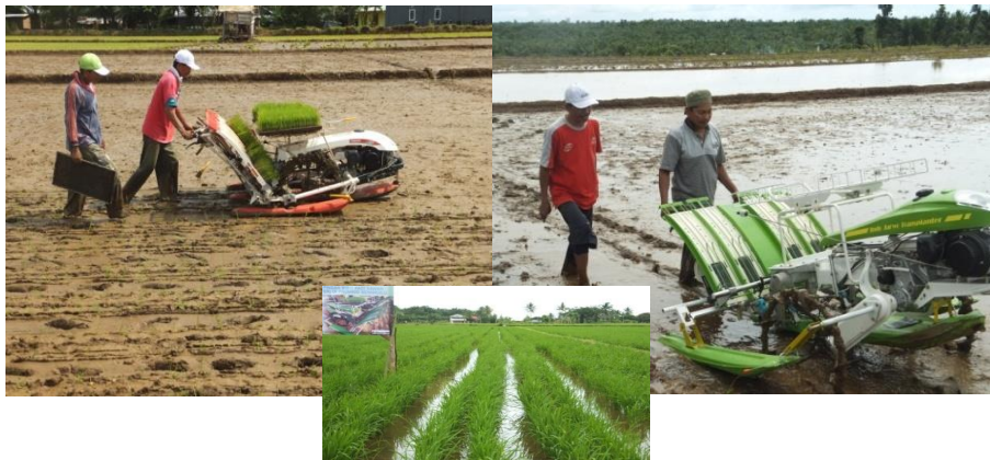
Gambar 13. Mesin tanam pindah Indo Jarwo Transplanter saat uji lapang di Provinsi Bengkulu
